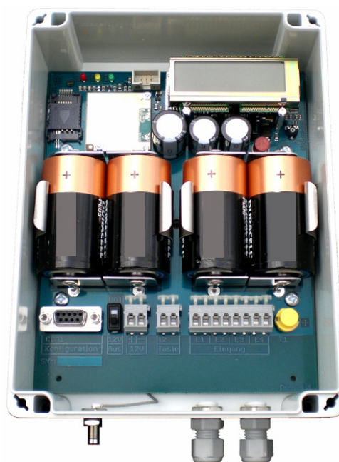
Rejestrator DL-DO z otwartą pokrywą oraz widok wyświetlacza w trybie standardowym.
